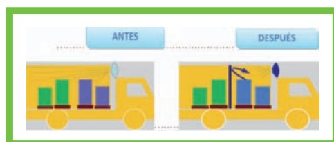
Instalación de un panel aislante móvil para separar carga refrigerada con producto no refrigerado en los camiones refrigerados
